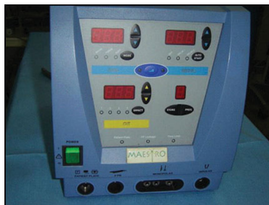
Fig. 7.4: Generador Electro-quirúrgico de Alta Frecuencia.
