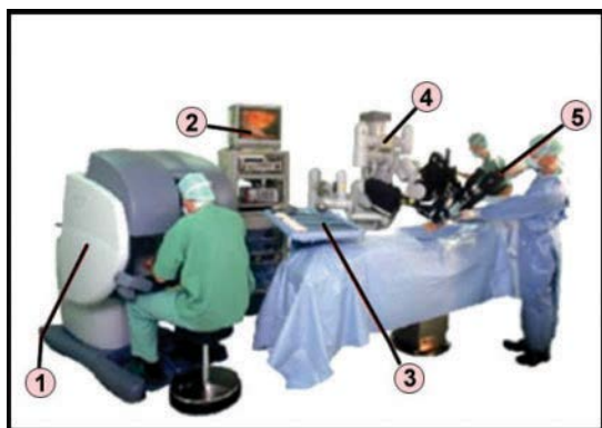
Figura. 46.3: Cirugía Robótica (1) Consola del cirujano (2) Equipo procesador de imágenes (3) Instrumentos de muñeca interna “endowrist” (4) Brazo quirúrgico (5) Endoscopio 3D de alta resolución.
