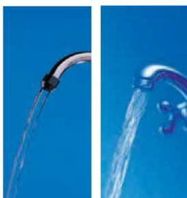
Figura 28: Izquierda: Flujo laminar. Derecha: Flujo Turbulento.
