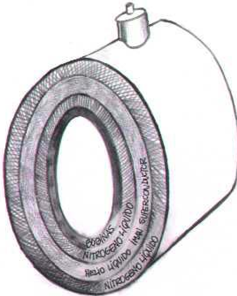
Figura 1-18: esquema del gantry de un resonador
