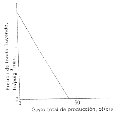
Figura 3.5 IPR que muestra que la formación es incapaz de tener el gasto de producción deseado.
